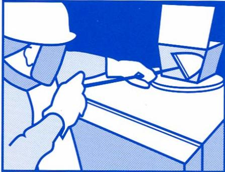
熔融镁能与铁氧化物发生放热反应产生 2200°C 的高温和大量的热。由于大多数熔炼锅是钢制的，因此保持锅内清洁，没有氧化铁皮是及其重要的。同样，铁皮应定期地从炉子上清除掉以避免锅坏时其与熔融镁发生反应。炉子所用的耐火材料应是高氧化铝或氧化镁质的，因为陶瓷材料中即使含极少量硅石，熔融镁也会与其发生激烈反应。应预备腾挪平底锅以备熔炼锅损坏时之用。这些锅任何时候都要保持干燥且无氧化铁皮。
