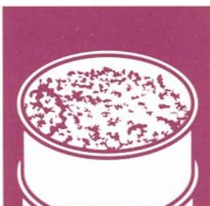
细状形态的镁是易燃的且在有水或含脂肪酸切削液存在的情况下能够自燃。氢还可以生成，遇火有爆炸的危险。含镁粉尘，当空气与粉尘浓度比达到临界值时，如果被点火，就会燃烧并伴随剧烈爆炸。在有镁机加工、锯削或制粉的地方必须禁止抽烟、使用明火和电焊接。所有电器连接和电机都必须是防爆的。在有镁粉尘存在的地方必须使用不产生火花的工具。
